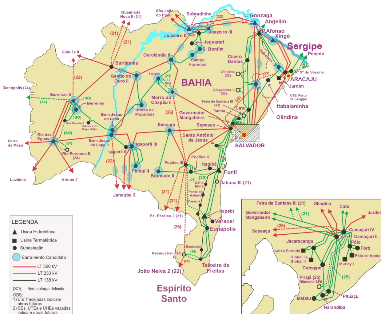
Figura 8-10: Sistema elétrico do estado da Bahia
